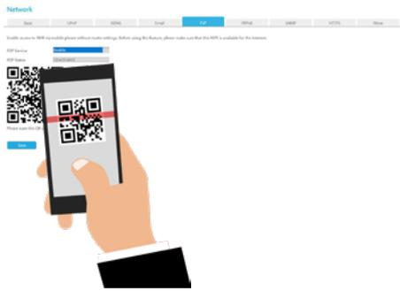
Die Verbindung über P2P vereinfacht den Fernzugriff. Für die Mobile-App braucht nur ein QR-Code App eingescannt werden. Alternativ unterstützt die Kamera auch DynDNS.
