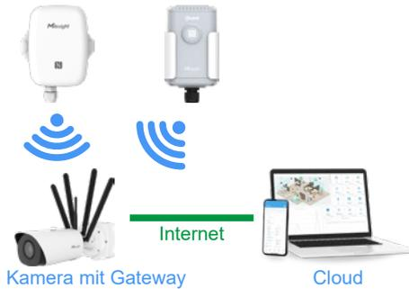
Die Kamera hat ein integriertes LoRaWAN-Gateway. LoRaWAN-Sensoren und Messgeräte können direkt mit der Kamera verbunden werden.
